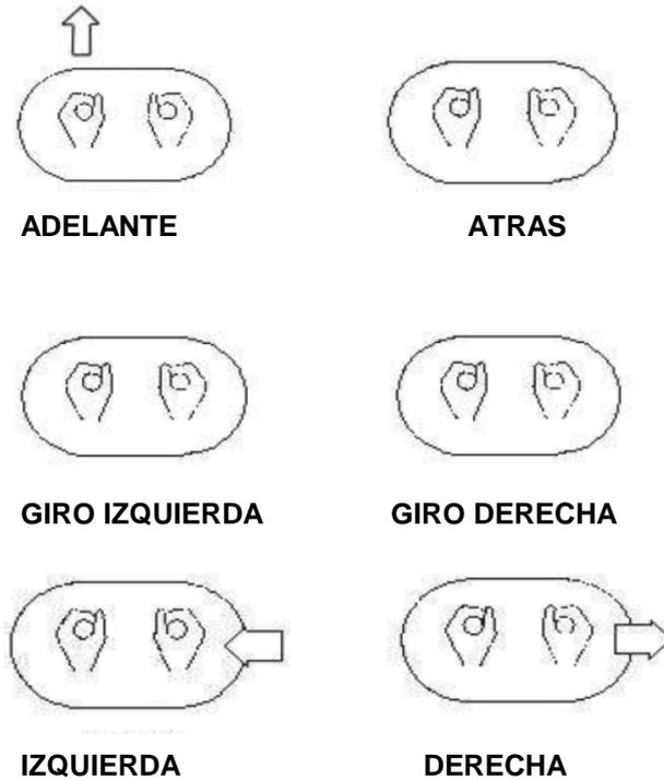
Maniobrar con la máquina es sencillo, pero requiere familiarizarse con ella antes de iniciar el trabajo. Los mandos responden según el esquema de la Figura 2a, Probar la máquina en una superficie terminada, con las paletas horizontales y el motor bajo de revoluciones para coger el punto justo de conducción.
