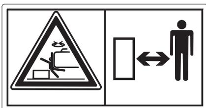
La indicación advierte del peligro de aplastamiento por la rotación de la estructura superior de la máquina.
