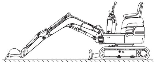
Posición para comprobar el nivel del aceite hidráulico
