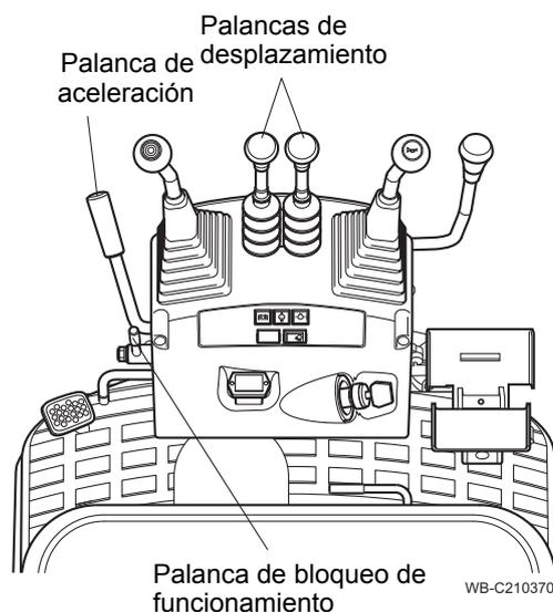
1. Tire de la palanca de aceleración para aumentar la velocidad del motor hasta alcanzar la velocidad necesaria para desplazarse.
