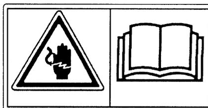
La indicación advierte del peligro de descarga eléctrica al manipular el cable.
