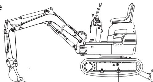
Eleve la máquina hasta que las zapatas se separen del suelo.
