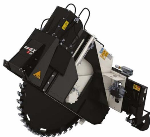
Diseñadas para el montaje en minicargadoras, las ruedas zanjadoras Simex ofrecen distintas soluciones para **trabajar en superficies duras o compactas** como asfalto, hormigón o roca: cortes y perforaciones, excavaciones de sección predefinida, **minizanjás y microzanjás para cables de fibra óptica**.
