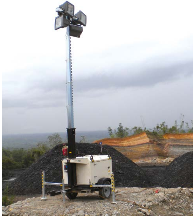
Linktower 4x400W de haluro metálico puede ser conectada a la toma de corriente auxiliar de una VT8 (3 kVA)
