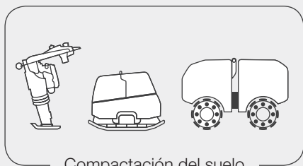
Compactación del suelo
