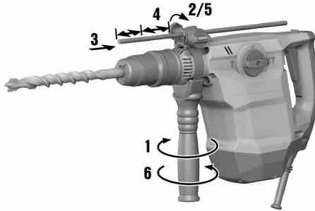
1. Gire la empuñadura para soltar el soporte (banda de sujeción) de la empuñadura lateral.
