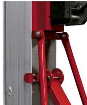
2 Estabilizadores de refuerzo para una mayor resistencia.
