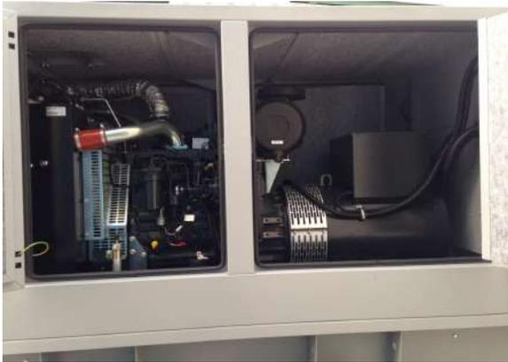
Montaje motor – Alternador.
