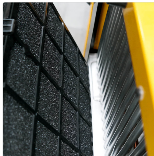
El filtro de aire de espuma compacto permite trabajar en espacios muy polvorientos
